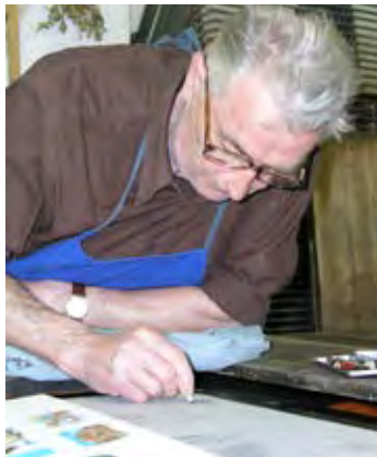
Práce výtvarníka na litografickém kameni upnutém v litografickém lisu je náročná, každá barva se tiskne zvlášť.
